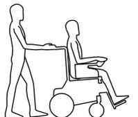
**ACHTUNG!!** Zum Entkuppeln der Räder muß die Bedienung ausgeschaltet sein. Ansonsten läßt sie einen Warnton hören. Um diesen auszuschalten, schalten Sie die Steuerung aus und bei eingekuppelten Rädern wieder ein.
